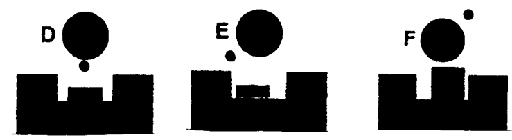
A : Résultat d'une visée parfaite B à F : Exemples d'erreurs angulaires
